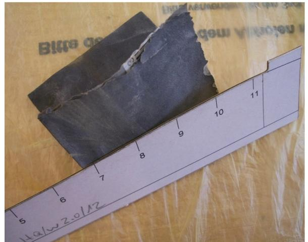
Die Schablonen werden mit Nadeln (Rouladenspieße) an die Styroblöcke gesteckt. Damit beim Wechsel vom Unterzug auf Oberzug die Steckpositionen identisch sind, werden beide Schablonen miteinander durchbohrt.
