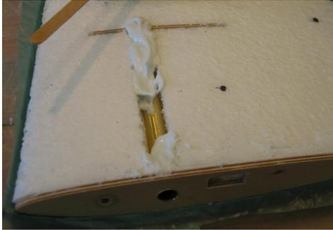
Die freiliegende Steckung muss noch aufgefüttert werden. Das geht ganz hervorragend mit einer aufschäumenden Epoxy/Mikroballon-Pampe. Ein paar eingerührte Tropfen vom EP-Treibmittel bringt Volumen in die weiche Masse welche bis in die kleinsten Ritzen eindringt!!
