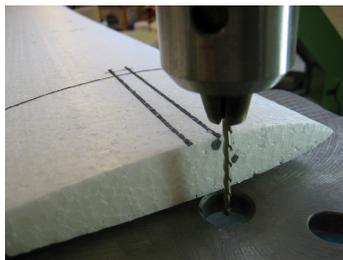
Das Styro wird zum Einkleben der Steckung mit den erforderlichen „Ausfräsungen“ (frei Hand an der Tischbohrmaschine) versehen.
