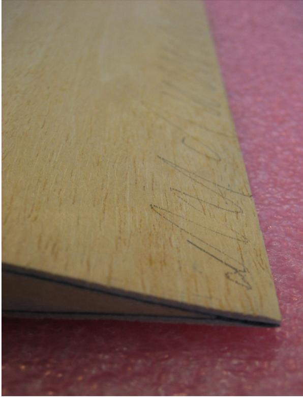
An der mit Cfk unterlegten Endleiste ist deutlich zu sehen, das die Beplankung stark aufträgt und daher spitz zugeschliffen werden muß. Mit einem weichen Bleistift wird das Holz markiert. Durch diese Maßnahme sieht man beim schleifen die Bereiche, welche noch nicht dem genauen Profilverlauf folgen.
