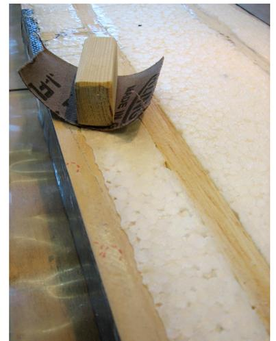
Die „Intro“-Nasenleiste erstelle ich aus Cfk-Rovings. Hierzu wird ein schmaler Streifen Styro entfernt und die Rovings ein,- bzw. aufgelegt.
