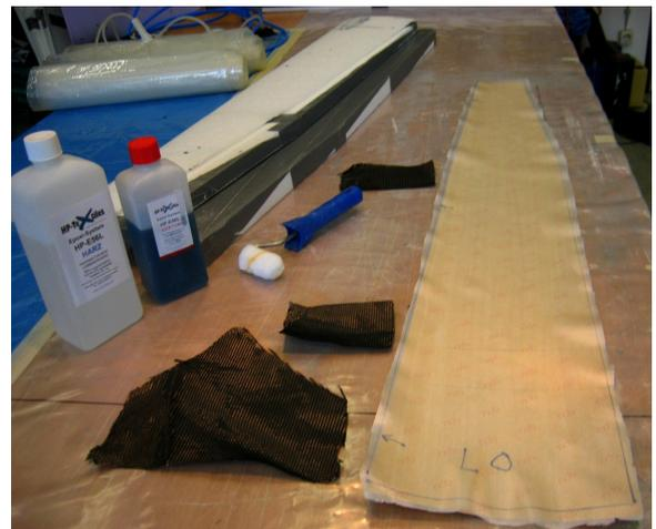
Glas,- und CfK-Gewebe sind fertig zugeschnitten. Die „Flächenpresse“ ist einsatzbereit. Nun wird Harz angerührt und EP-Treibmittel beigemischt. Das Glasgewebe liegt trocken ausgerichtet auf dem Holz. Mit dem Filzroller ist das Harzgemisch fix und gleichmäßig aufgetragen. Nun werden noch die CfK Gewebestücke aufgelegt und ebenfalls mit Harz getränkt.
