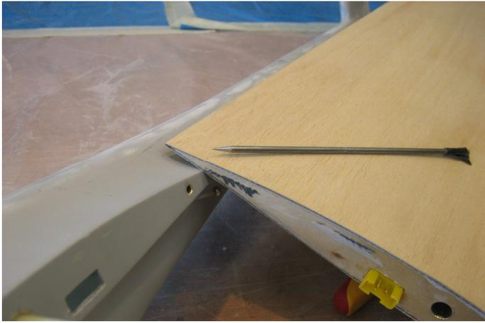
Was noch fehlt sind die Torsionsstifte gegen das Verdrehen der Flügel – sollen ja keine Rotationstragflächen werden. Die Markierung wird mit einem spitz geschliffenen Stahldraht gesetzt. Hierzu wird der Flügel am Rumpf aufgeschoben und die Endleiste in Flucht zur Profilanformung fixiert – die Nadel wird durch das Messingröhrchen des Rumpfes geschoben und in das Holz der Wurzelrippe gedrückt. Die Fläche wird wieder abgenommen und mutig mit der Handbohrmaschine aufgebohrt.
