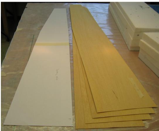
Damit das Furnier nicht unnötig Harz aufsaugt und so leicht wie möglich bleibt, bekommt die Klebeseite eine sparsame Versiegelung mit einer Holzgrundierung (Schnellschleifgrund). Die Gewichtszunahme durch diese Maßnahme beträgt insgesamt 15 Gramm.
