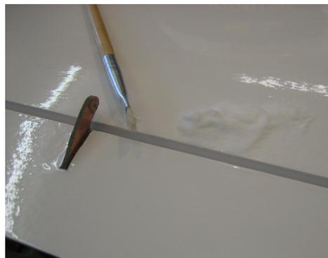
Jetzt die Kreppsteifen wieder entfernen. Ruder aufklappen und Mikroballons in den Spalt träufeln – mit dem Pinsel vorsichtig verteilen. Die freie Tesaklebefläche ist nun klebefrei ☺.
