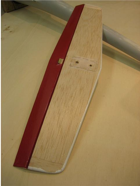
Die HR-Unterseite bespanne ich in zwei Schritten. Zuerst das Ruder – dann die Dämpfungsfäche. Das SR ist auch schon foliert und provisorisch am Rumpf angeschlagen.
