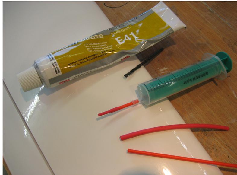
Die Kanüle der Spritze wird auf 3mm aufgebohrt; jetzt passt da ein Stück Bowdenzugröhrchen hinein. Da noch ein Stück Schrumpfschlauch drüber und fertig ist die Silikoniermaschine.
