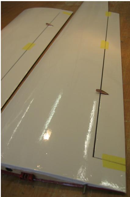
Ich beginne mit dem silikonieren der WK. Deren Drehachse liegt auf der Unterseite damit das Ruder auch tief genug (Butterfly) abgesenkt werden kann.
