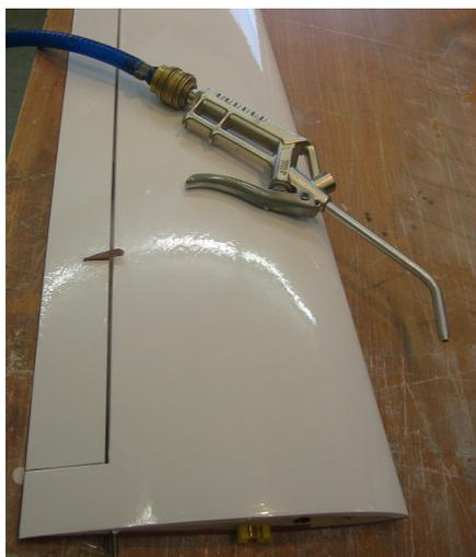
Direkt vor dem Silikonieren müssen natürlich die Mikroballons aus dem Spalt wieder raus. Mit sanfter Pressluft und anschliessendem nachputzen mit einem sauberen weichen Lappen ist der Spalt wieder blitzblank.
