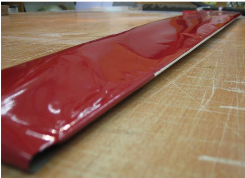
Zunächst wird mit dem Bügeleisen gearbeitet. Die Folie wird ringsum an Nasen,- und Endleiste an,- und umgebügelt.
