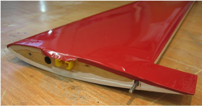
An der Wurzelrippe bleibt an der dicksten Stelle des Profils ein Stück Folie unangebügelt – beim späteren Spannen können hierdurch die unweigerlich entstehenden Gase entweichen.
