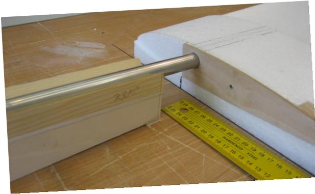
Die Styroporschale ist exakt auf dem Bautisch ausgerichtet und die Steckungseinheit parallel zur Tischkante positioniert. Lieber einmal mehr nachmessen!
