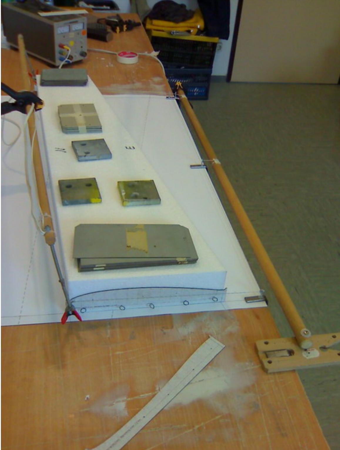
Der Schneidebogen wird mit zwei (Lenkdrachen-) Schnüren, über Umlenkungen geführt, durch das Styropor gezogen.
