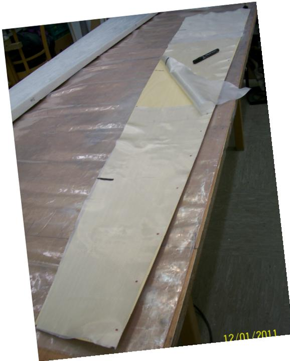
Los geht's: Am Randbogen beginnen. Der Estrichkleber wird immer nur über die jeweilige Gewebestücklänge auf das Furnier aufgetragen und sofort mit dem Zahnpachtel verteilt - den Überschuss in Richtung Wurzelrippe sorgfältig abziehen. Gegebenenfalls überschüssigen Leim auf einem Schmierbrett abgestreifen. Das Glasgewebe wird behutsam aufgelegt und ein wenig angedrückt - groß verschieben (\*) lässt sich das Gewebe dann nicht mehr, man muss es schon recht genau auf dem Holz aufbringen!
