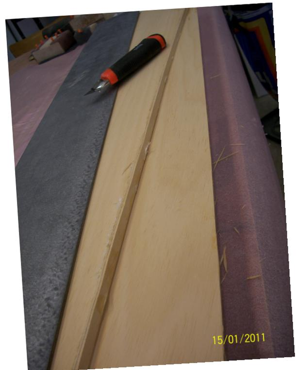
Beim Glätten einer gewölbten Oberfläche setzt darauf achten, das die Schleifrichtung immer im 45° Winkel zur Flugrichtung erfolgen muß - sonst produziert man Wellen, Riefen und Dellen!
