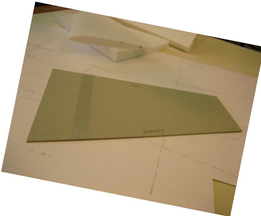
Pappschablonen kommen als „Datenträger“ und Bauhilfe zur Anwendung. In diesem Fall zum zuschneiden der Styroporblöcke von Tragflächen bzw. dem Höhenruder.
