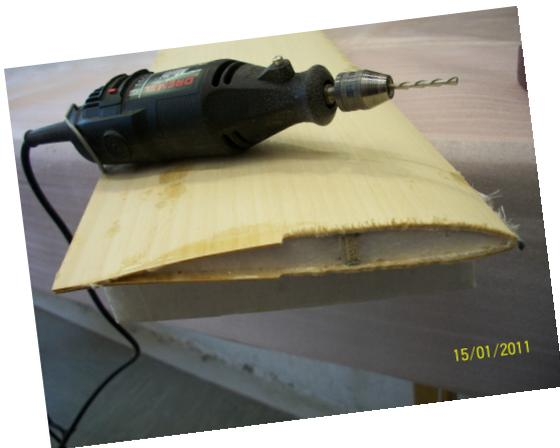
Zunächst wird das überstehende Furnier an Wurzelrippe und Tragflächenende grob besäumt. Der geniale Dremel-Fräser läuft wie Butter durch das Material und lässt sich präzise frei Hand führen.
