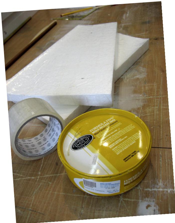
Beim Verpressen des Furniers mit dem Styroporkern muss eine **Schutzfolie** zwischen Holz und Styropordeckel gelegt werden. In diesem Fall versuche ich mal was anderes: Mit klarem Paketklebeband werden die Styropordeckel versiegelt und zusätzlich mit Trennmittel unverklebbar gemacht. Effekt - kein verrutschen der schlabbrige Trennfolie mehr.
