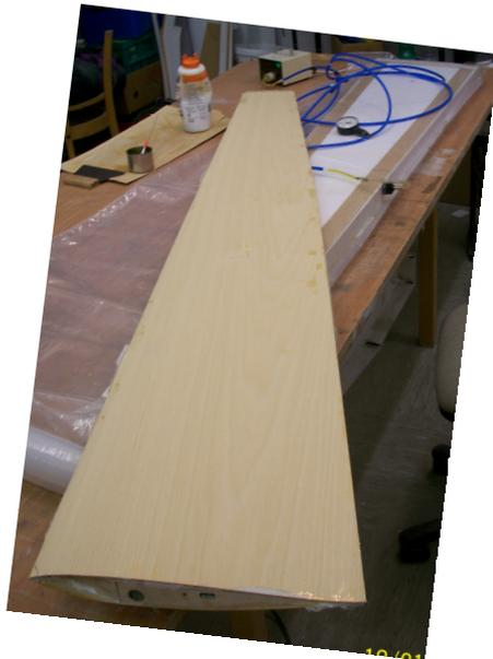
Die erste Tragflächenhälfte ist nun fertig beplankt und wird noch einige Tage vollends durchhärten - erst dann beginnt die Schleiforgie, Nasenleiste ankleben, Ruder ausschneiden usw.....
