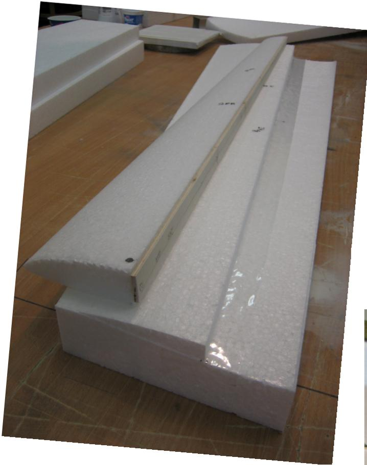
Nachdem die Holmsteghöhen feststehen, werden diese etwas überbreit ausgesägt und am Bandschleifer passgenau hergerichtet. Mit etwas Estrichkleber erfolgt das Verkleben mit dem Styroporkern. Im nächsten Schritt werden Außen,- und Innenflügel stumpf aneinander geklebt - die Schalen natürlich auch.
