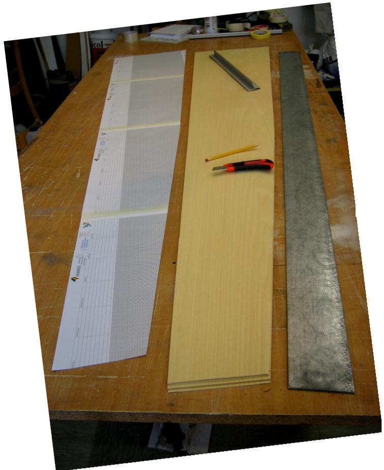
Würde ich das Furnier mit Epoxydharz verkleben wollen, müsste nun zum Sperren der Holzoberfläche ein Anstrich mit Porenfüller oder Schnellschleifgrung erfolgen. Das ist aber bei der Verwendung des PU-Leims nicht erforderlich und erwünscht - der geringe Nachteil in der höheren Klebstoffmenge = Klebstoffgewicht wird dadurch zum Teil wieder ausgeglichen.
