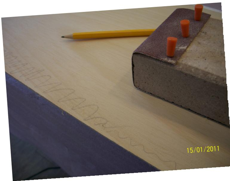
Die Graphitstriche helfen beim endgültigen Zuspitzen der Endleiste zu erkennen, ob das Material gleichmäßig abgetragen wird. Unebenheiten, die sonst nur mit den Fingern ertastbar sind, werden nach dieser Methode sichtbar.
