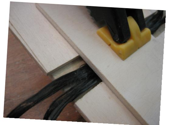
Rechnerisch geht das aber auch: **Ein einzelner mit Harz getränkter NF24 Roving hat eine Oberfläche von  $1,4\text{mm}^2$  -> 10 Rovings benötigen also  $14\text{mm}^2$ . Bei einem Stegdurchmesser von 4mm beträgt die erforderliche Bauhöhe  $14\text{mm}^2/4\text{mm} = 3,5\text{mm}$  !**
