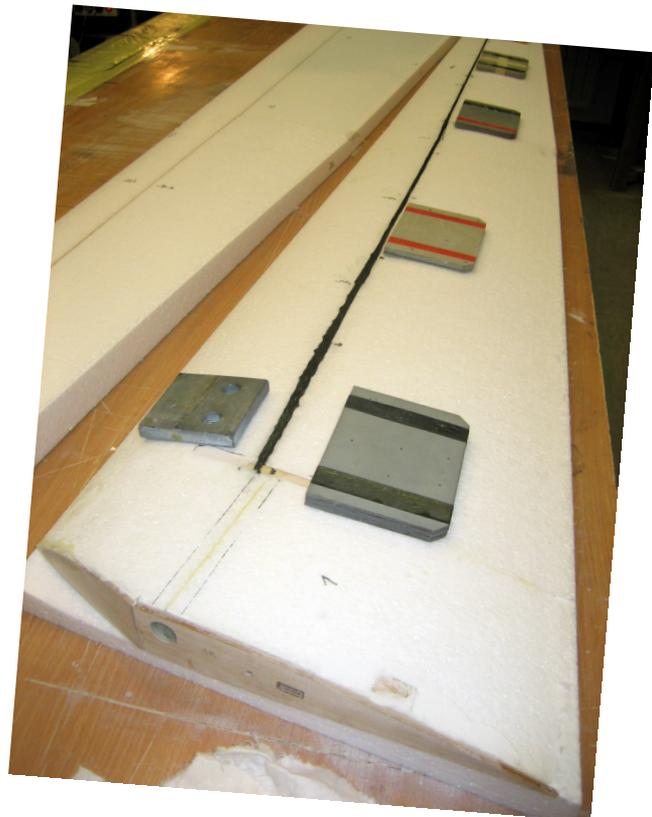
In die Servokabelkanäle werden noch vor dem Aufpressen des Abachifurniers über die gesamte Tragflächenlänge Hilfsschnüre eingelegt. Später lassen sich hiermit die Servokabel problemlos einziehen!
