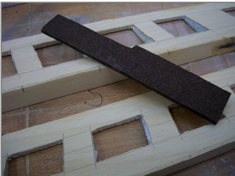
Die Feile besteht aus einer mit 100er Schleifpapier beklebten 20mm breiten Kiefernleiste. Damit werden die Ränder der zuvor freihändig ausgefrästen Rippenfelder fein nachgeschliffen beziehungsweise begradigt.
