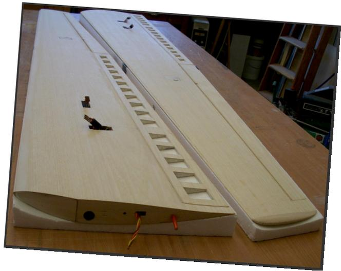
Zum Einziehen der Servokabel sind die Litzen vorübergehend miteinander verlötet. Das hält mehr Zug aus und trägt weniger dick auf als eine Verbindung mit Tesafilm.
