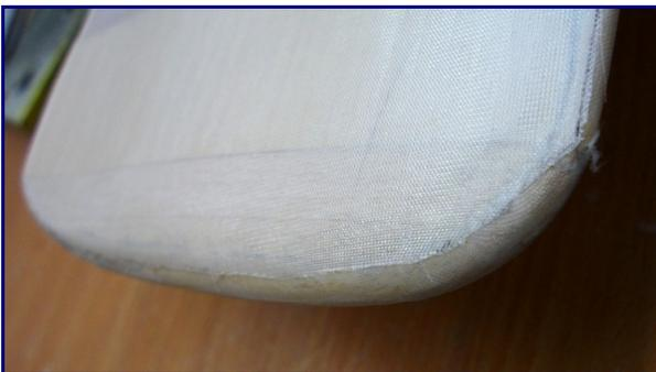
Am Randbogen wird genau so Verfahren wie an der Nasenleiste.
