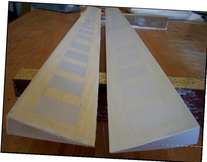
24.05.11 Das üble Geschmiere mit dem Bügeleisen im feuchten Parkettlack hat mich dazu bewogen bei der zweiten WK-Unterseite nun das Gewebe vollflächig mit dem Heißsiegelkleber aufzubügeln. Die Gewebeüberstände lasse ich wieder stehen und lackiere sie gleich mit - erst nach Durchtrocknung werden sie abgeschnitten und geschliffen; da franst nichts mehr aus! Ein weiterer Vorteil: die freien
