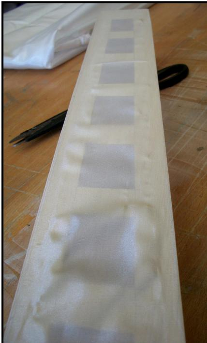
Die Endleiste wird beidseitig mit Heissiegelkleber eingestrichen - ebenso die komplette Stirnseite und ein schmaler Bereich an der Nasenleiste des Ruders. Das zugeschnittene Gewebe wird auf der Profiloberseite heiss angeheftet und zur Unterseite hin umgeschlagen. Vor dem anbügeln wird es noch mit einer Schere beschnitten.
