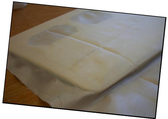
Nun wird das Gewebe an Randbogen und anschliessend an der Wurzelrippe angebügelt. Das restliche Gewebe wird auf die Gegenseite des HR umgeschlagen und nach gleichem Verfahren fixiert. Lediglich der Gewebeüberstand an der Endleiste wird (noch) nicht abgeschnitten. Die ätzenden Falten (aus der Verpackung heraus) verschwinden beim Föhnen.
