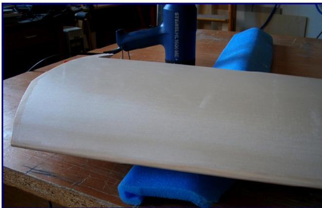
Das Gewebe liegt nun straff auf dem Furnier auf, ist aber noch nicht mit ihm verklebt. Der erste Anstrich mit dem Parkettlack versiegelt das Gewebe und verbindet es dauerhaft mit dem Holz. Das Holz saugt sich ebenfalls mit dem Lack voll und wird dadurch spürbar härter.
