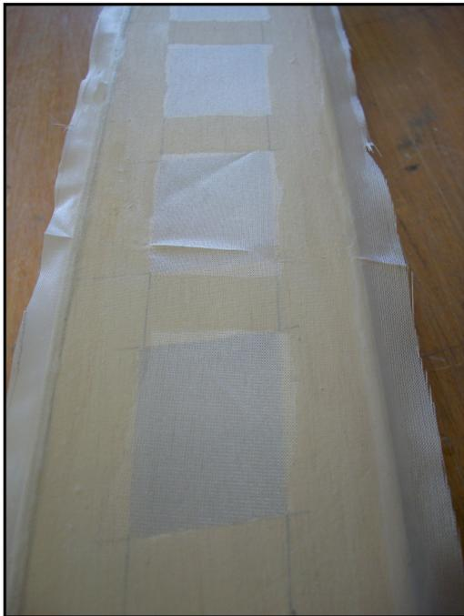
Die freien Rippenfelder werden beim ersten Lackauftrag nicht mit eingestrichen. Erst nach dem Durchtrocknen wird das zum Teil faltige Gewebe mit dem Föhn gespannt und anliessend lackiert.
