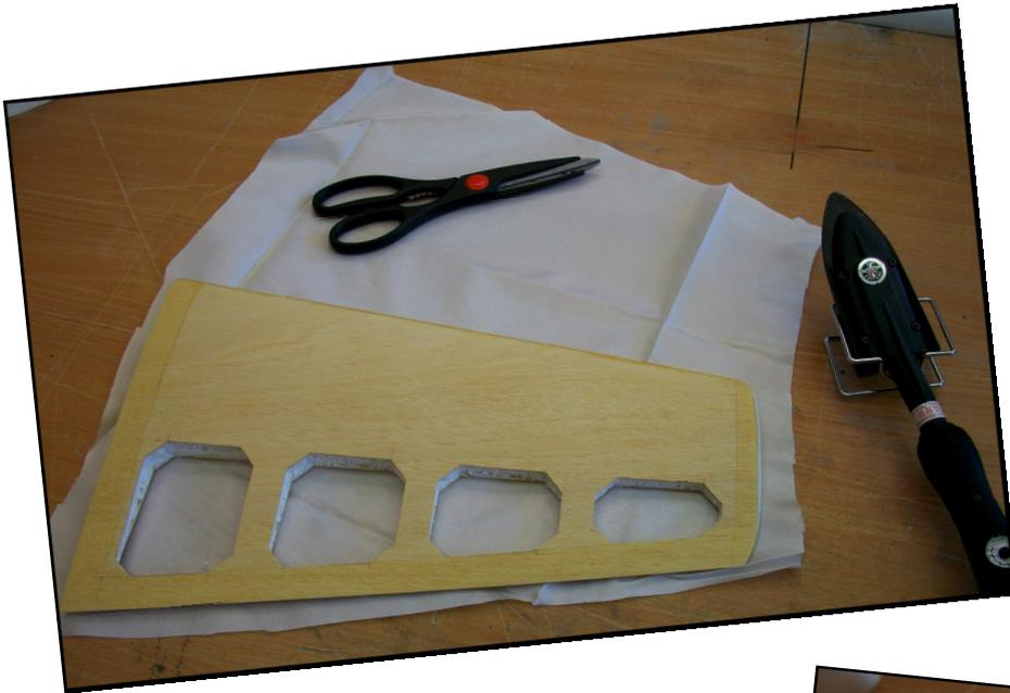
13.05.11 Das HR wird in einem Stück mit dem Koverall bespannt. Zuerst wird das Gewebe entlang der Nasenleiste angebügelt. Dann wird es an der Endleiste mit dem heißen Eisen fixiert und der Überstand mit einer scharfen Klinge abgeschnitten.
