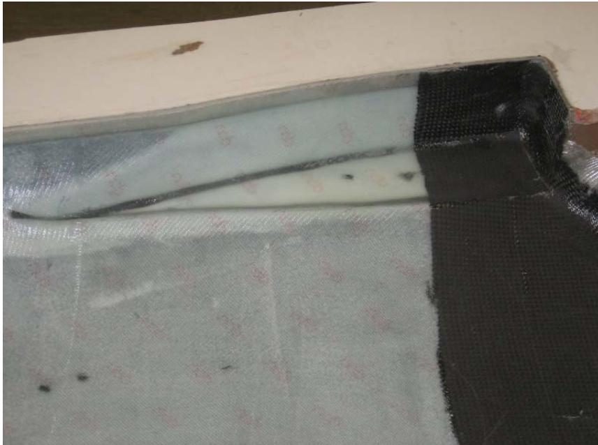
9. Nun 3mm dicke und 5cm breite Styroporstreifen als Stege (Spanten) in Rumpfröhre und Seitenruderfinne einkleben. Mit zähflüssigen Harzresten geht das sehr gut. Zuvor die Styrostreifen mit schräg angesetztem Messer abschneiden - das auflaminierte Gewebe wird sich dann nicht mehr abheben und einen Hohlraum bilden!
