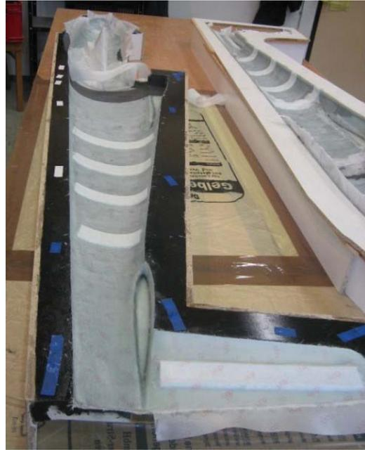
8. Zur direkten Verstärkung im Bereich von Tragflächensteckung zum Fahrwerk hin, wird ein 10cm breites CfK-Gewebe (90°/90°) einlaminert.
