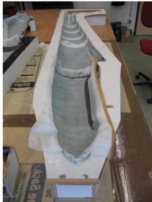
11. Nach 24 Stunden Trockenzeit wird das Abreissgewebe vorsichtig vom Laminat abgezogen und die Formenränder noch einmal so gut es geht von Gewebeüberständen befreit. Ich habe das mit einem Schleifklotz gemacht.
