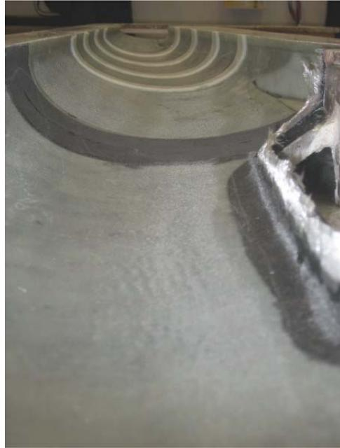
10. Nach dem behutsamen Besäumen des Gewebes an den Formenrändern wird ganzflächig Abreissgewebe auf das noch feuchte Laminat aufgebracht.
